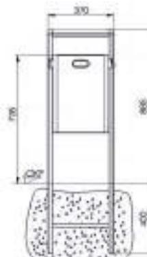
Frontansicht zum Einbetonieren 7083-70
