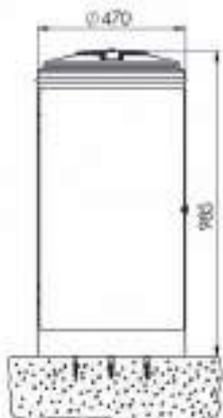
Montage auf Betonfundament
