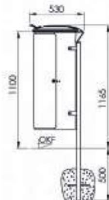
Seitenansicht 8059-01 zum Einbetonieren
